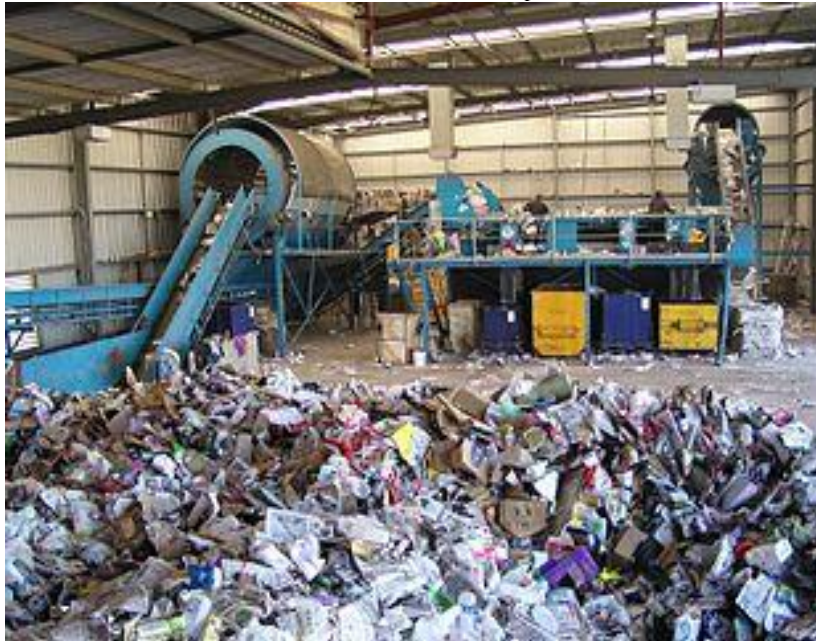
Impianto di separazione a freddo della componente secca per l'ulteriore recupero di materiali da riciclare.
